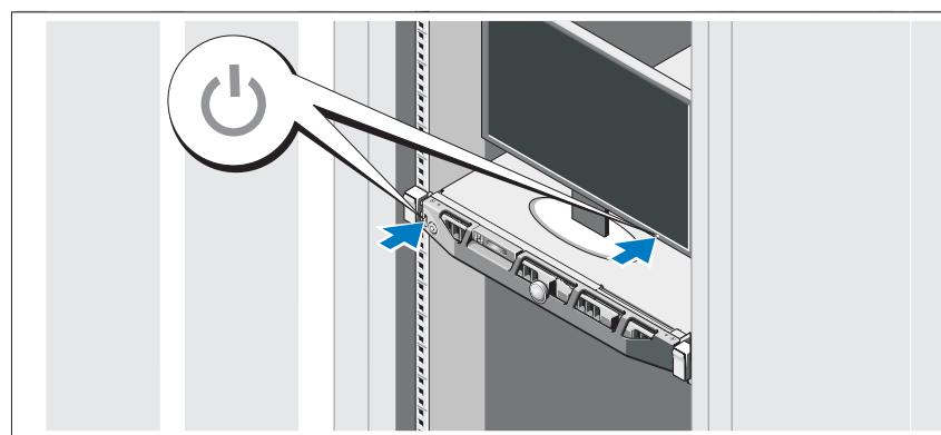
Presione el botón de encendido del sistema y del monitor. Los indicadores luminosos de alimentación deberían encenderse.
