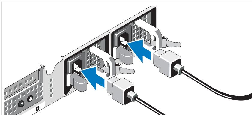
Conekte o(s) cabo(s) de alimentação ao sistema e, se for usado um monitor, coneke o cabo de alimentação ao monitor.
